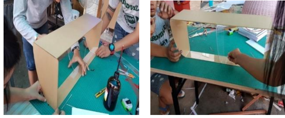
ภาพที่ 7 นำที่ครอบมาเก็บงานตามมุมตามขอบรอยต่อของงานไม่ให้เกิดความคม เพื่อป้องกันการเกิดอุบัติเหตุที่อาจจะเกิดขึ้นได้ในอนาคต
