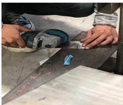
ภาพที่ 6 แสดงการขัดแผ่นผิวให้เรียบ และขัดเงาให้เรียบเนียนโดยการนำแผ่นเรียบมาขัดสแตนเลสเพื่อให้เกิดความเงา และความเรียบเนียน
