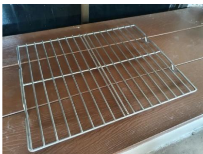
ภาพที่ 11 แสดงตัวอย่างโมเดลที่ขึ้นรูปโครงและเชื่อมฐานตะแกรงเรียบร้อยแล้ว
