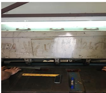
ภาพที่ 3 แสดงแผ่นสแตนเลสที่เครื่องตัดแผ่นสแตนเลสที่นำมาใช้ โดยเลือกสแตนเลสเกรด 304 เท่านั้น เพราะเกรด 304 สามารถใช้สำหรับอาหารได้และไม่ก่อให้เกิดสนิม
