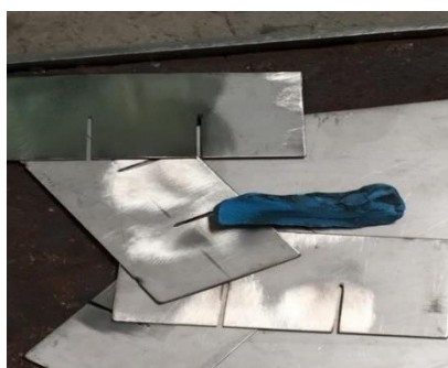
ภาพที่ 5 แสดงการใช้ปากเพื่อทำร่องให้ประกอบเข้ากันได้ตามรูปแบบ โดยการทำให้เป็นช่องครึ่งหนึ่งของแผ่นสแตนเลสให้ครบทั้ง 4 แผ่นในขนาดที่เท่ากัน เพื่อให้สแตนเลสประกบกันในขนาดที่พอดี
