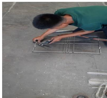
ภาพที่ 9 แสดงการวัดขนาดและเชื่อมร่อง หรือ ช่องไฟที่ใช้เป็นฐานตะแกรง
