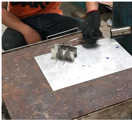
ภาพที่ 8 แสดงใส่ที่มีมือจับโดยการนำเส้นสแตนเลสมาดัดขึ้นรูป ตามแบบ เพื่อเป็นด้ามจับสำหรับตัดขนมปัง
