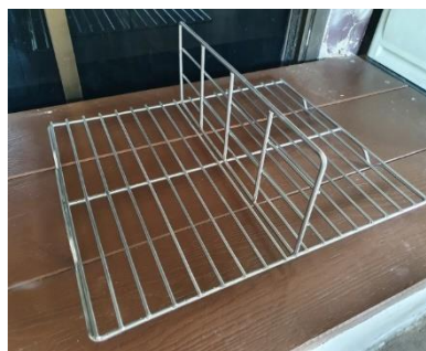
ภาพที่ 11 แสดงตัวอย่างโมเดลที่ขึ้นรูปโครงและเชื่อมฐานตะแกรงเรียบร้อยแล้ว
