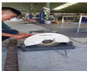
ภาพที่ 5 แสดงการตัดเหล็กตามขนาดทีออกแบบไว้
