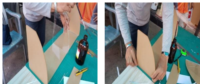
ภาพที่ 6 นำชิ้นส่วนแต่ละชิ้นเข้ามาประกอบเข้าด้วยกันโดยใช้น้ำยาเชื่อมแผ่นอะคริลิก ทาตามจุดที่กำหนดไว้เพื่อให้ได้ตามที่แบบต้องการ
