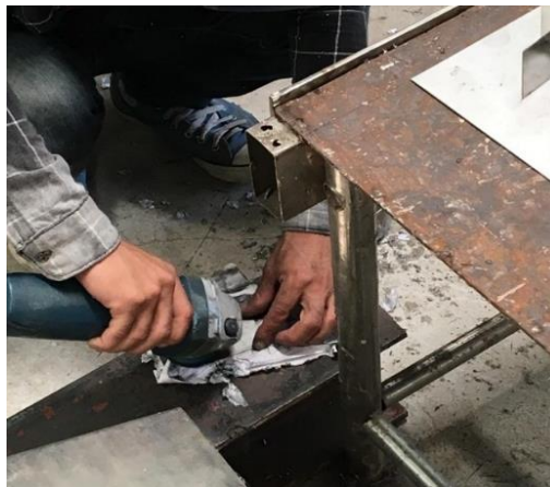
ภาพที่ 9 แสดงการลบรอยเชื่อมให้ชิ้นงานเพื่อให้เกิดความสวยงาม โดยการใช้เครื่องเจียร์ลบรอยตำหนิให้กับสแตนเลสเพื่อให้ชิ้นงานเกิดความสวยงาม
