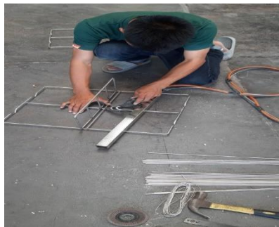
ภาพที่ 9 แสดงการวัดขนาดและเชื่อมร่อง หรือ ช่องไฟที่ใช้เป็นฐานตะแกรง
