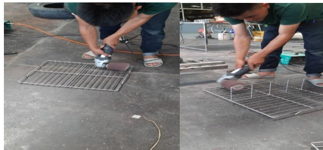
ภาพที่ 10 แสดงกับขัดและเก็บรายละเอียดชิ้นงาน
