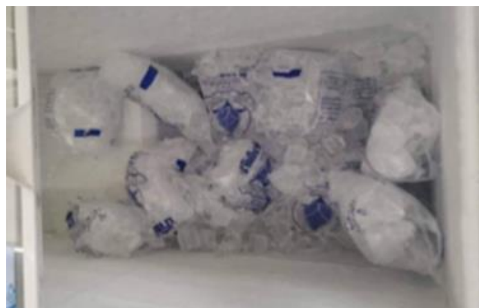
ภาพที่ 2. ถุงน้ำแข็งมีการฉีกขาดเกิดขึ้น เมื่อมีการดึงถุงน้ำแข็งที่ติดกับแผ่นฟรีซ
